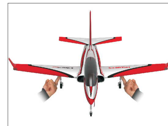
测试重心的通用方法。 A general method for testing CG.
